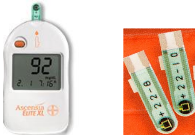
Abb. 2-3: Ascensia® Elite XL Sensorgerät und Ascensia® Elite Sensoren [Ascensia® Elite XL Bedienungsanleitung; 1999,2002 Bayer Vital, USA]
