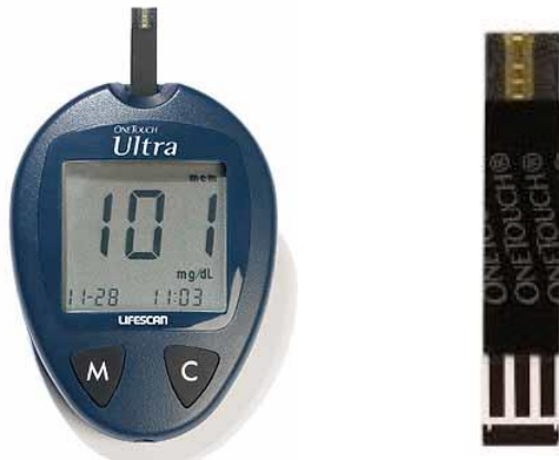
Abb. 2-7: OneTouch® Ultra™ Sensorgerät und OneTouch® Ultra™ Teststreifen [OneTouch® Ultra™ - Benutzerhandbuch, 2002, LifeScan Deutschland, Ortho-Clinical Diagnostics GmbH, Neckargemünd]
