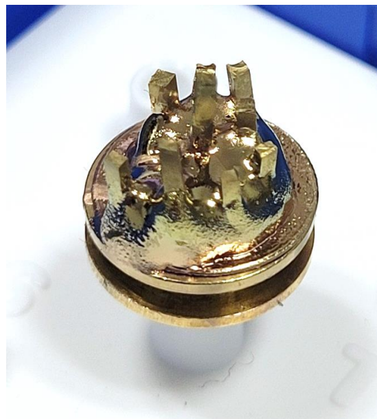
Abbildung 15: Dentinfragmente nach Sputtern auf einem Probenteller [Eigene Aufnahme]
