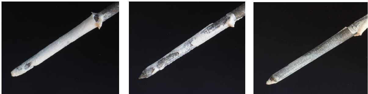
Abbildung 8 - Beispielhafte Darstellung der Frakturmodi: adhäsiver Bruch zum Dentin, gemischter Bruch, kohäsiver Bruch
