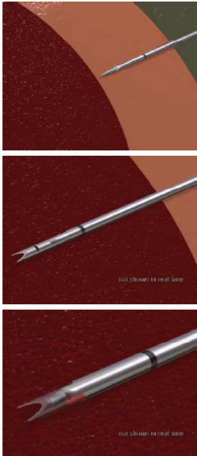
Abb. 4: Prinzip der Probengewinnung mit dem, Endschnittechnologie verwendenden, BioPince™ Biopsieinstrument.
